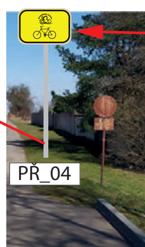
INSTALACE IS21a (MLYNÁŘSKÁ) NA NOVÝ SLOUPEK, V KOTEVNÍ PATCE POZEMEK: PARC. Č. 210/1, K. Ú. PŘEŠOVICE (OBEC PŘEŠOVICE)
