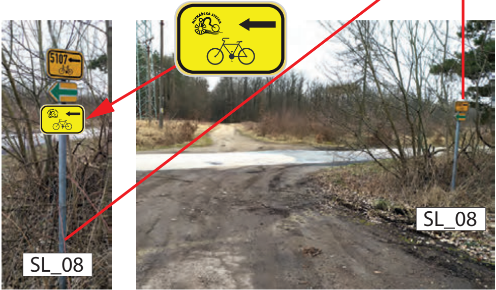
INSTALACE IS21b (MLYNÁŘSKÁ) NA STÁVAJÍCÍ SLOUPEK CYKLOTRASY UMÍSTĚNÍ POD STÁVAJÍCÍ ZNAČENÍ
