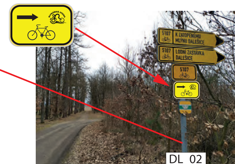
INSTALACE IS21c (MLYNÁŘSKÁ) NA STÁVAJÍCÍ SLOUPEK CYKLOTRAS UMÍSTĚNÍ MEZI STÁVAJÍCÍ ZNAČENÍ
