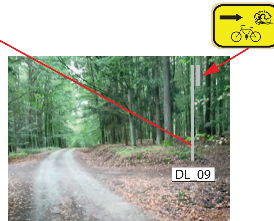
INSTALACE IS21c (MLYNÁŘSKÁ) NA NOVÝ SLOUPEK V ZEMNÍ BETONOVÉ PATCE, POZEMEK: PARC. č. 707, K. Ú. DALEŠICE (LESY ČR)
