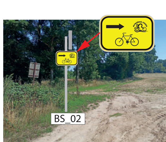
INSTALACE IS21b (MLYNÁŘSKÁ) A IS21c (MLYNÁŘSKÁ) NA NOVÝ SLOUPEK SPOLEČNÝ PRO OBA SMĚRY V ZEMNÍ BETONOVÉ PATCE POZEMEK: PARC. č. 1479/47, K. Ú. BISKUPICE U HROTOVIC (OBEC BISKUPICE - PULKOV)
