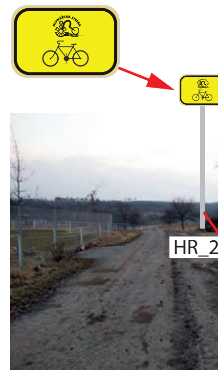
INSTALACE 2x IS21a (MLYNÁŘSKÁ) NA NOVÝ SLOUPEK SPOLEČNÝ PRO OBA SMĚRY POZEMEK : PARCELA Č. 942/2, K. Ú. HROTOVICE (OBEC MĚSTO HROTOVICE)
