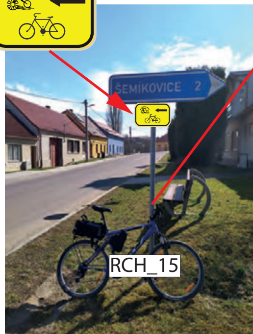
INSTALACE IS21b (MLYNÁŘSKÁ) NA SLOUPEK DOPRAVNÍHO ZNAČENÍ UMÍSTĚNÍ POD STÁVAJÍCÍ ZNAČENÍ
