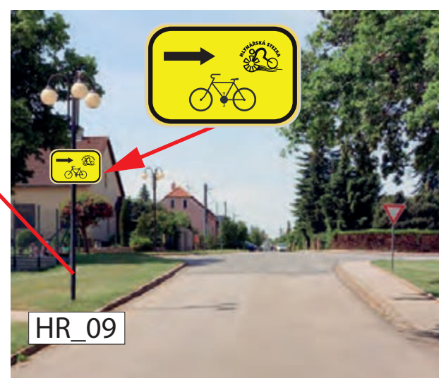
INSTALACE IS21c (MLYNÁŘSKÁ), NA SLOUP VEŘEJNÉHO OSVĚTLENÍ
