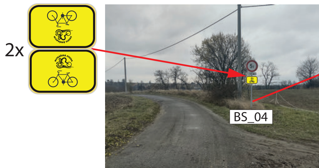
INSTALACE 2x IS21a (MLYNÁŘSKÁ) NA SLOUPEK DOPRAVNÍHO ZNAČENÍ, SPOLEČNÝ PRO OBA SMĚRY, UMÍSTĚNÍ 1X POD STÁVAJÍCÍ ZNAČENÍ A 1X Z RUBU DZ
